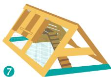
Coupez 2 planches et vissez-les sur les montants latéraux à l'avant et à l'arrière. Grillagez les autres côtés.
