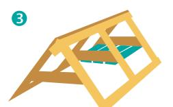
Fabriquez le plancher en vissant des planches par le dessous, sur les planches transversales.
